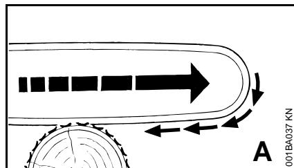
Ako pri rezanju donjom stronom vodilice – rez prednjom rukom – lanac testere zaglavi ili naleti na tvrdi predmet u drvetu, motorna testera može biti naglo
