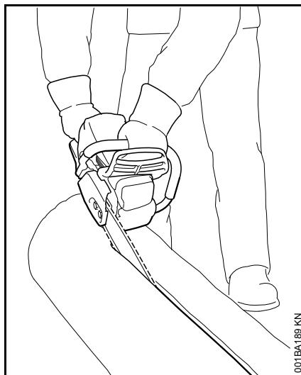
Tehnika testerisanja bez kandžastog odstojnika – opasnost od uvlačenja – prislonite vodilicu pod što je moguće manjim uglom – radite posebno pažljivo – povećana **opasnost od povratnog udarca!**
