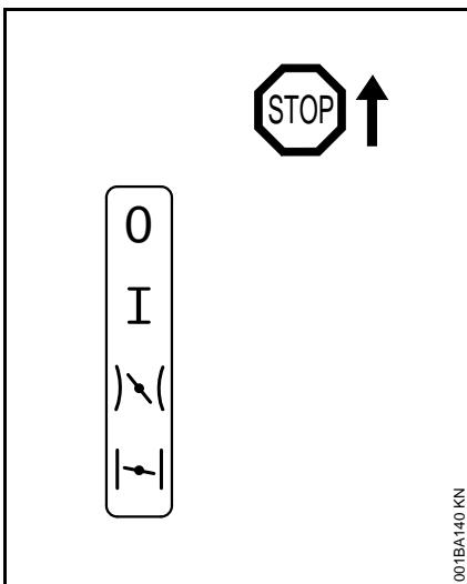
**Stop 0 – gašenje motora – paljenje je isključeno**
